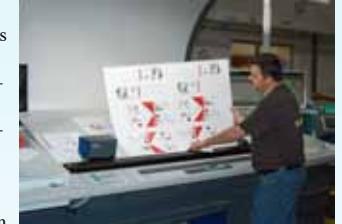
Der erste Auftrag 4-farbig+Dispersions- u. UV-Lack in einem Durchgang wird gedruckt. Drucker H. Can beim Abstimmen des Druckbogens.
